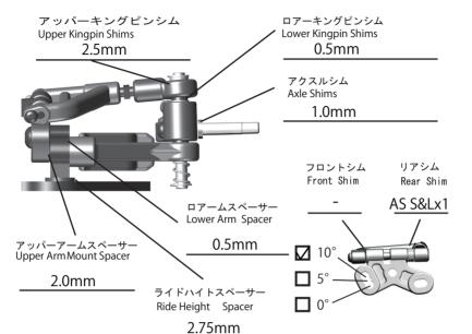
Ride Height 3.1 mm キャンバー Camber Angle 1.0 トー角 Toe Angle **OUT 1.0** ボディマウント **Body Mount**
